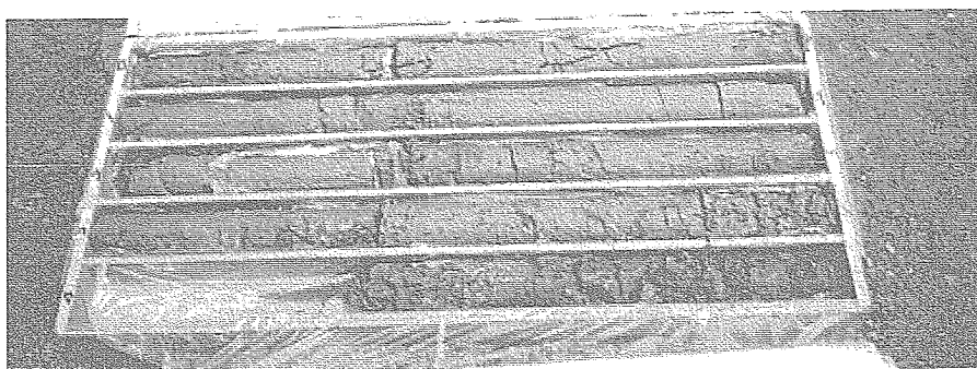
写真-5.10 チェックボーリングコアの写真(No.7 端部)
