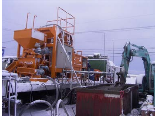
MP プラント (10 t 車, 車載設置)
