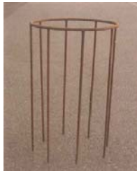
荷重分散層袋材作成治具
