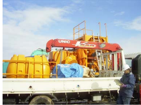
固化材小運搬用 4 t ユニック
