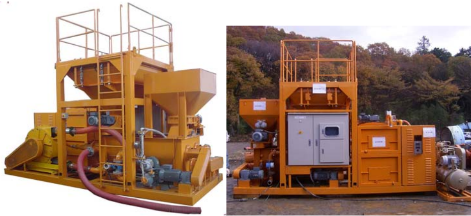
写真-1.1.1 MPプラント本体
