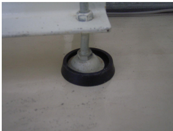
図 2.2 試験台脚のゴム製カバー
