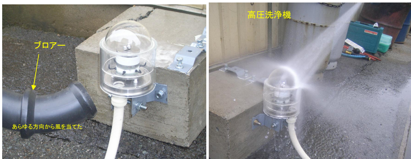
図 7.3.1 風に対する挙動(左) と暴風雨に対する挙動(右) の確認状況
