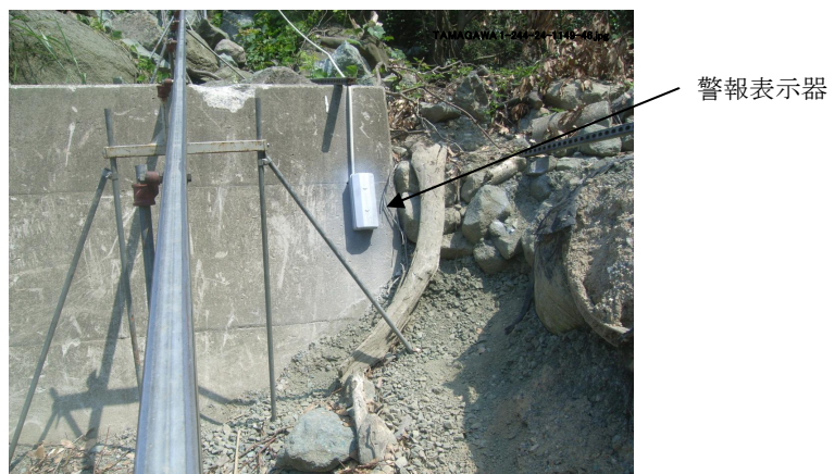
図 8.1.4 警報機設置状況（道路パトロールおよび対策施工者が確認）
