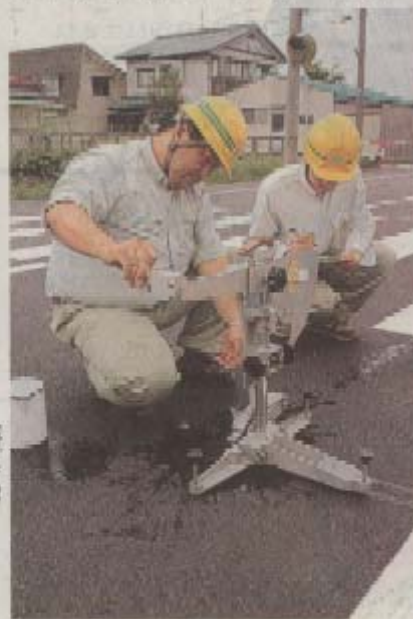
木タールを併せたアスファルト舗装材を試験施工した。福井市春江町西長州。抗凍融試験を福井高専グループのメンバーが実施。八月三日、福井市春江町西長州
