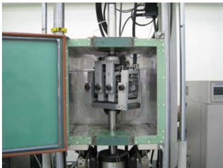
図3 破壊輪数（せん断強さ）を評価するための繰り返し曲げ試験
