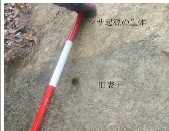
図-4.6.1 滑落崖に認められる旧表土と崖錐性堆積物
