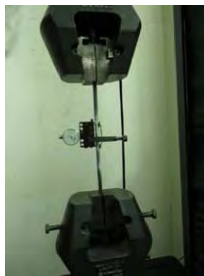
写真-5.2.12 伸び計によるひずみ計測
