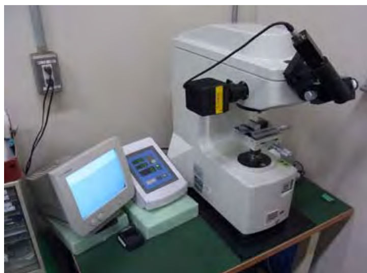
写真-5.2.14 ミットヨ製硬度測定器 HM
