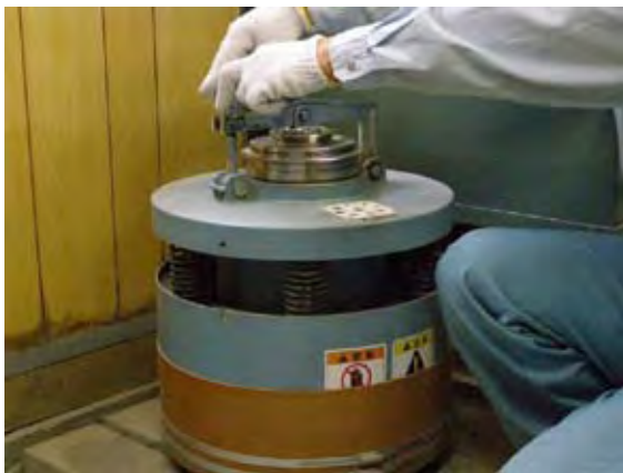
添付写真-3 振動ミルによる微粉碎
