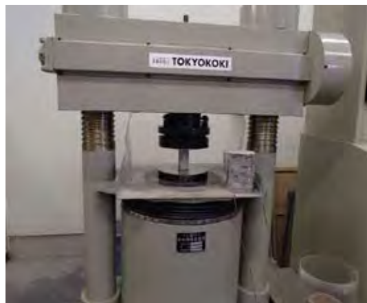
写真-6.2.1 圧縮強度試験および静弾性係数試験の状況
