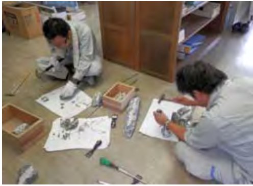
写真-5.2.5 グラウトの採取状況
