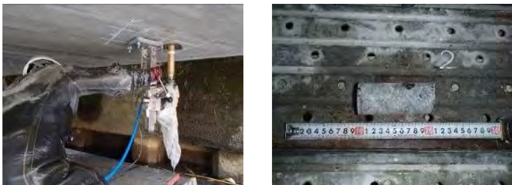
写真-5.1.6 コア供試体採取状況
