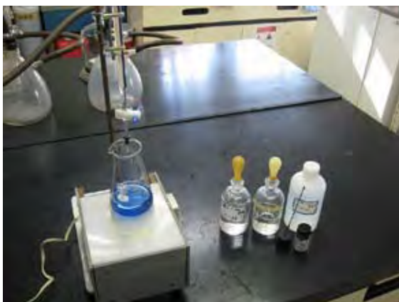
添付写真-5 酸化カルシウム量(キレート適定)
