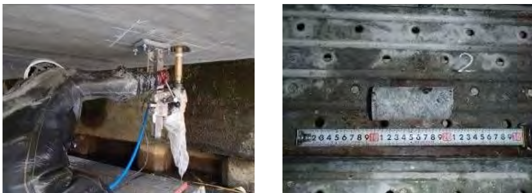
写真-1 コア供試体採取状況
