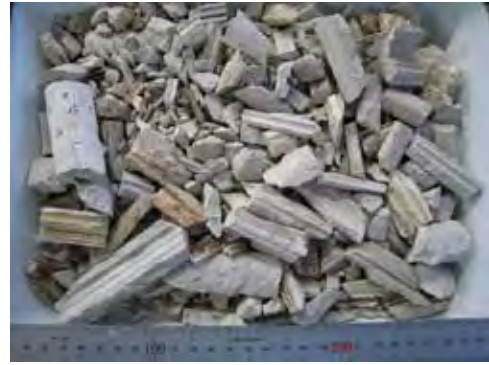
写真-5.2.5 グラウトの採取状況
