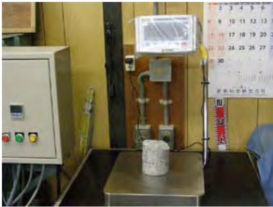
添付写真-1 単位容積質量測定状況
