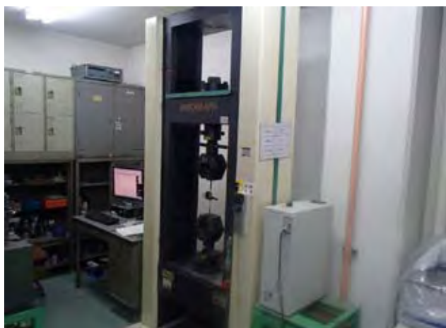
写真-5.2.11 引張試験機 AG-250kNXplus
