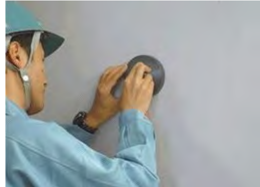
写真-3.2 チャンバー設置状況
