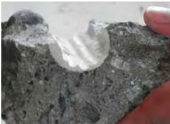
写真-5.2.2 PC グラウト試料の採取状況
