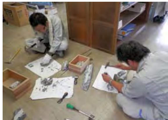
写真-5.2.2 PC グラウト試料の採取状況
