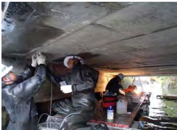
写真-2 表面法（土研法）による超音波伝搬速度測定状況
