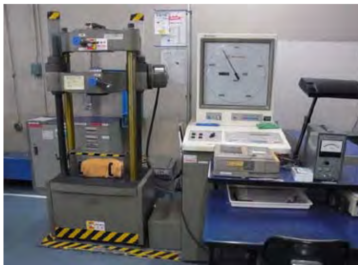
写真-5.2.13 引張試験機 UH-200KNA
