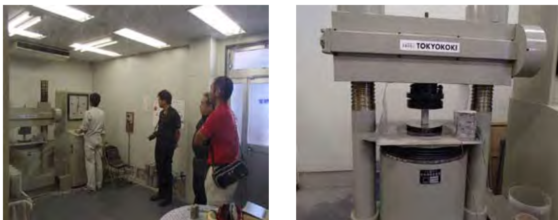
写真-2 圧縮強度試験および静弾性係数試験の状況
