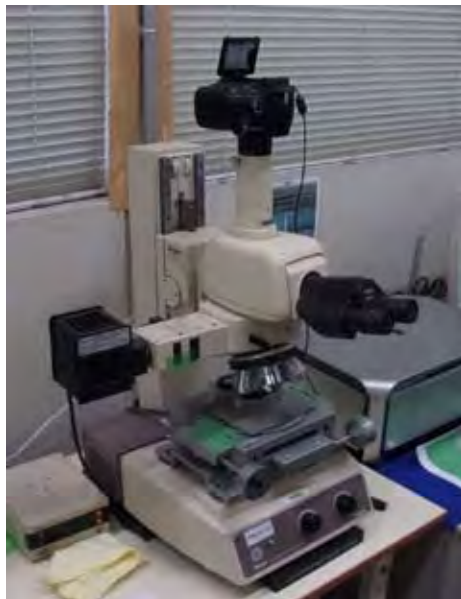
写真-5.2.17 ニコン製測定顕微鏡
