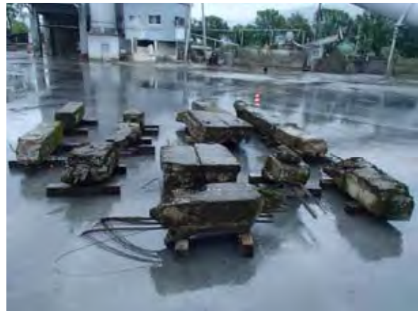
写真-4.2.10 回収した石徹白橋の橋桁片
