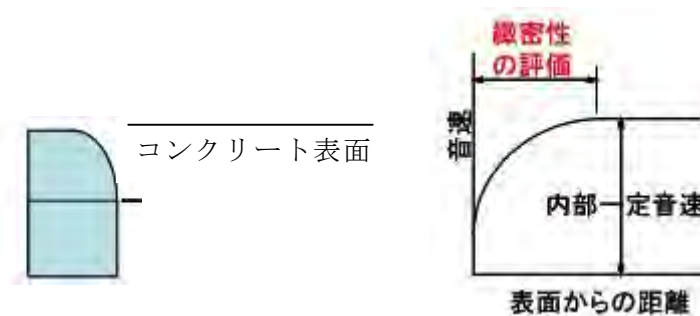
図-5.1.4 コンクリートの音速分布の例
