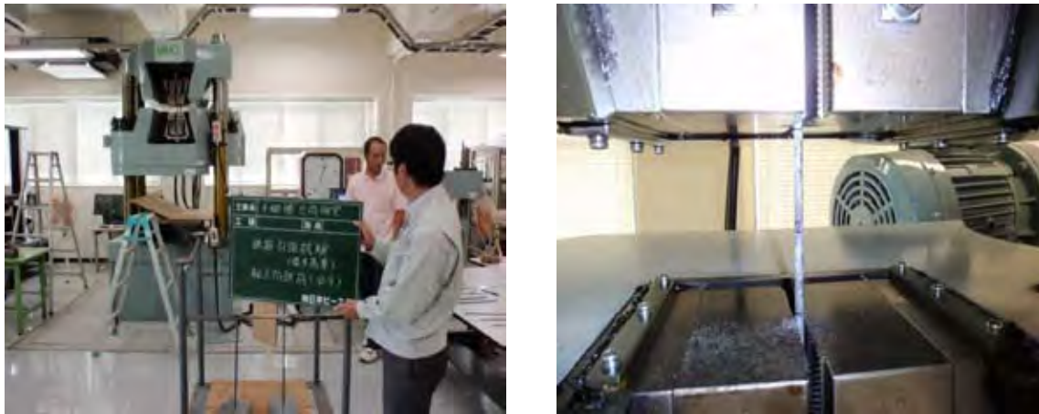
写真-2 引張強度試験の状況
