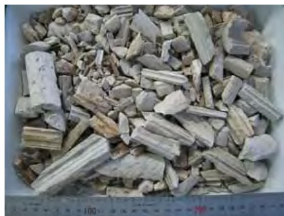
写真-2 PCグラウト片の外観
