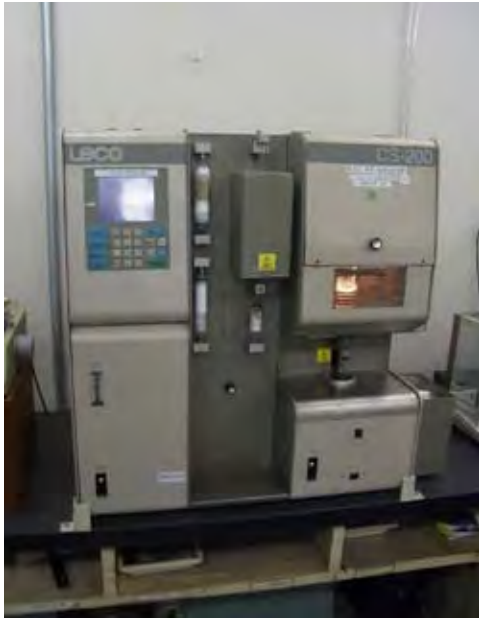
写真-5.2.15 炭素硫黄測定器
