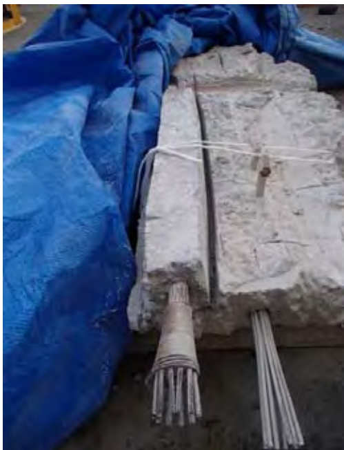
写真-6.4.3 石徹白橋のグラウト試料採取時の状況
