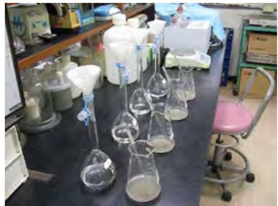
添付写真-4 希塩酸による分解・ろ過
