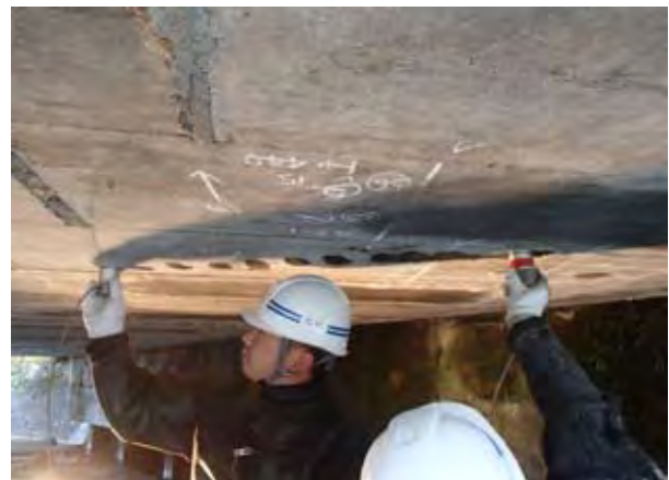
写真-2 表面法（土研法）による超音波伝搬速度測定状況
