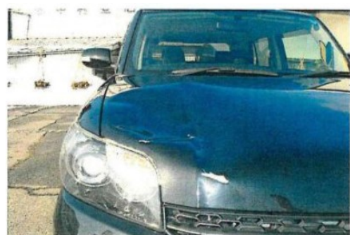
c) ボンネット部分に落雪（被害：ボンネットにへこみ）
