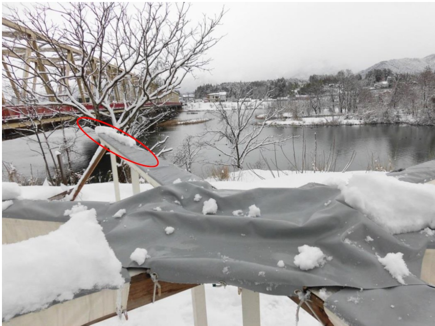
図 87 現地手動運転による落雪試験の様子 (2017 年 2 月 3 日)
