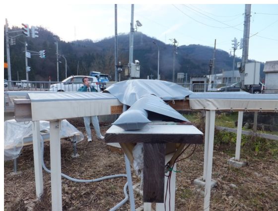
図 67 ブロアー (VB-001S-E) 送風後の膜膨張の様子 (ライズ 40mm)
