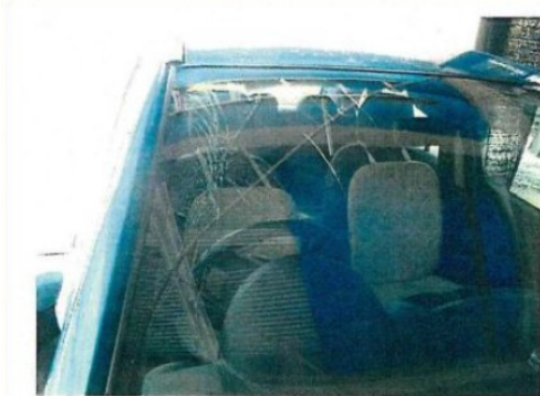
b) フロントガラス部分に落雪（被害：フロントガラスにヒビ）
