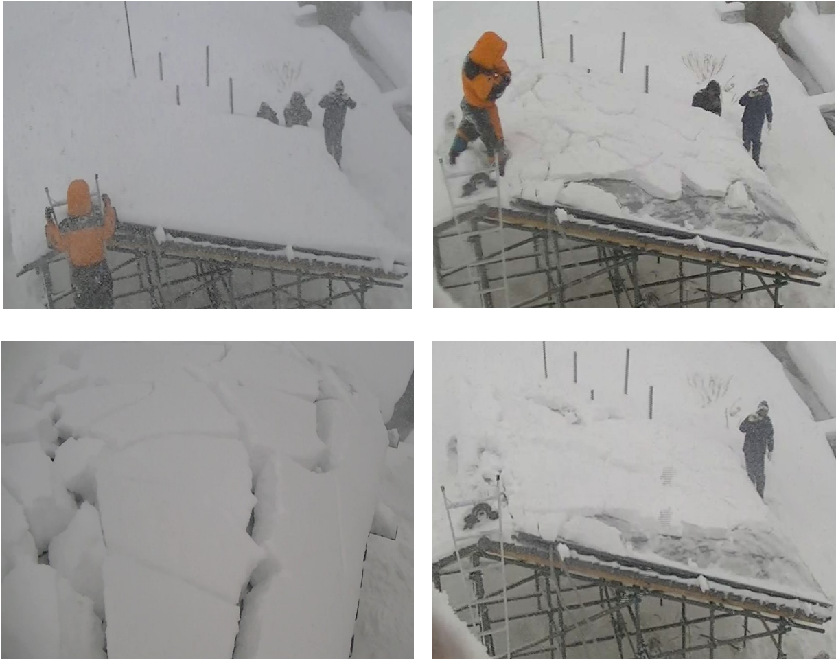
図85 雪密度の軽い新雪時の屋根雪落雪試験（2012年）
