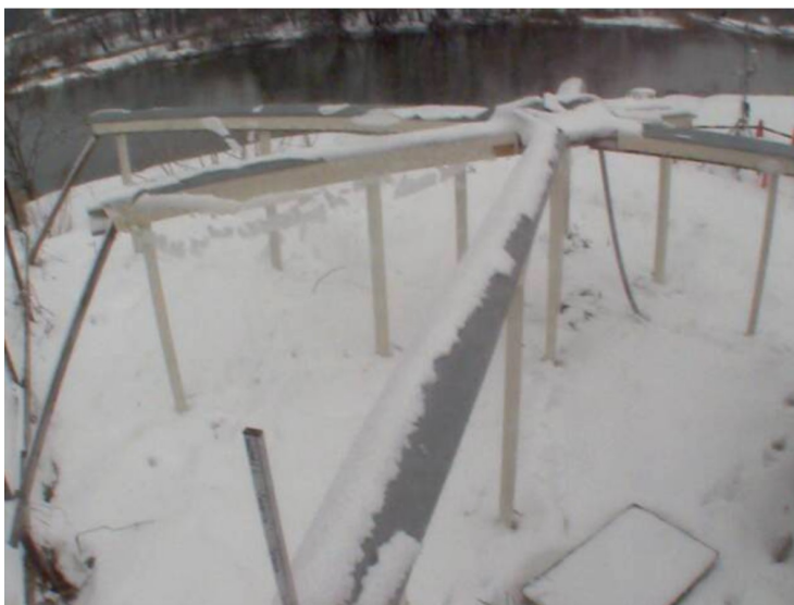
図 100 遠方自動運転による落雪試験(全景)の様子 (2017年2月21日 10:39)
