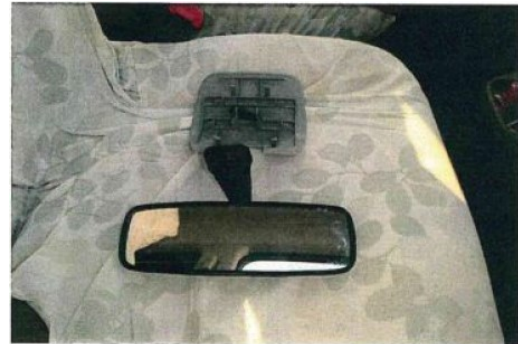
a) ルーフ部分に落雪（被害：ルーフのへこみ、ルームミラーの落下）
