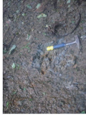
P-15 崩壊斜面の左岸側の上方斜面状況 斜面勾配36°
