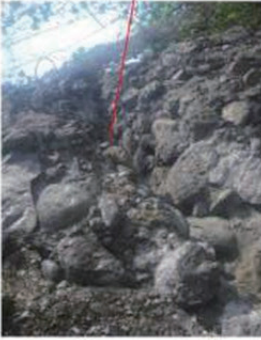
P-6 巨岩塊に挟在する砂岩の薄層 礫岩中の砂岩薄層の走向は北 17°。西で傾斜は 22°。東である。
