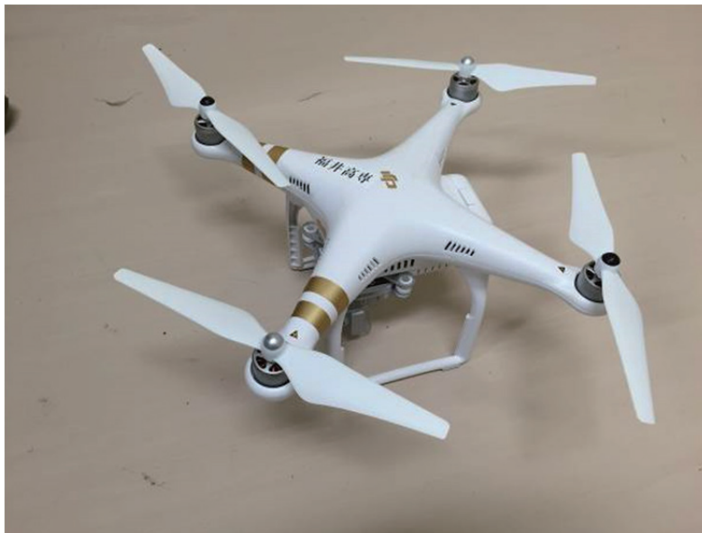
図-2.1.1 本調査で使用した UAV (DJI 社製 Phantom 3 Pro.)
