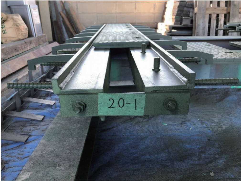
图 44 伸縮装置（伸縮量 20mm）断面形状
