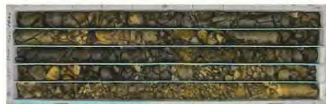
無水掘りや打ち込みにより採取しているため人為的な乱れが著しいコア
