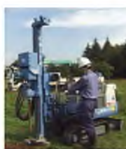
自走式ボーリングマシン（振動貫入式）
